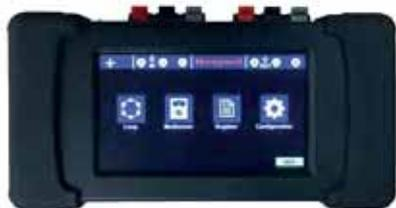
Herramienta de ayuda al instalador en la puesta en marcha y mantenimiento de los sistemas analógicos. Pantalla táctil en color con iconos de uso intuitivo. Permite diagnosticar el lazo antes de conectarlo a la central y realizar una verificación, indicar las direcciones de los equipos y las posibles direcciones duplicadas. Además, funciona como multímetro permitiendo detectar errores en el cableado.
