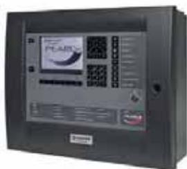
Central analógica algorítmica de 2 lazos con protocolo avanzado OPAL para la detección de alarmas de incendio que monitoriza y controla individualmente los elementos del sistema. Con certificado CPD EN54 parte 2 y 4.
