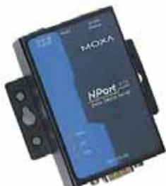
Redireccionador IP de puerto serie, para conexión del SEIKIT al software de gestión gráfica TG, mediante protocolo IP. Compatible con redes Ethernet a 10 y 100 MHz. Dispone de entrada a puerto serie RS232, conexión Ethernet y alimentación de 24 V.
